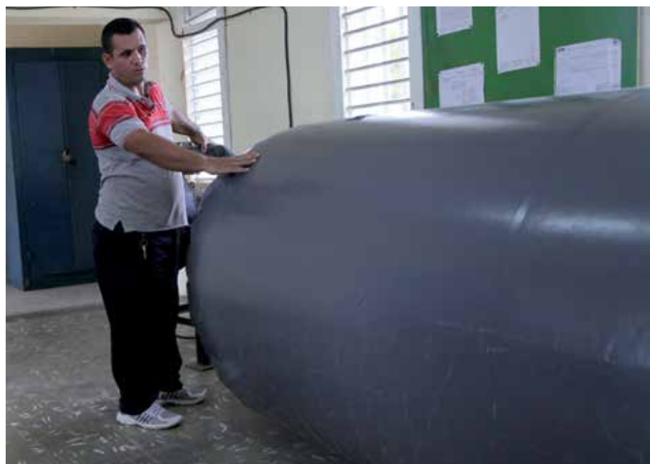
Biodigestor de membrana de polietileno o tipo salchicha fabricado en la Empresa Militar Industrial de Sancti Spíritus. /Foto: Oscar Alfonso
