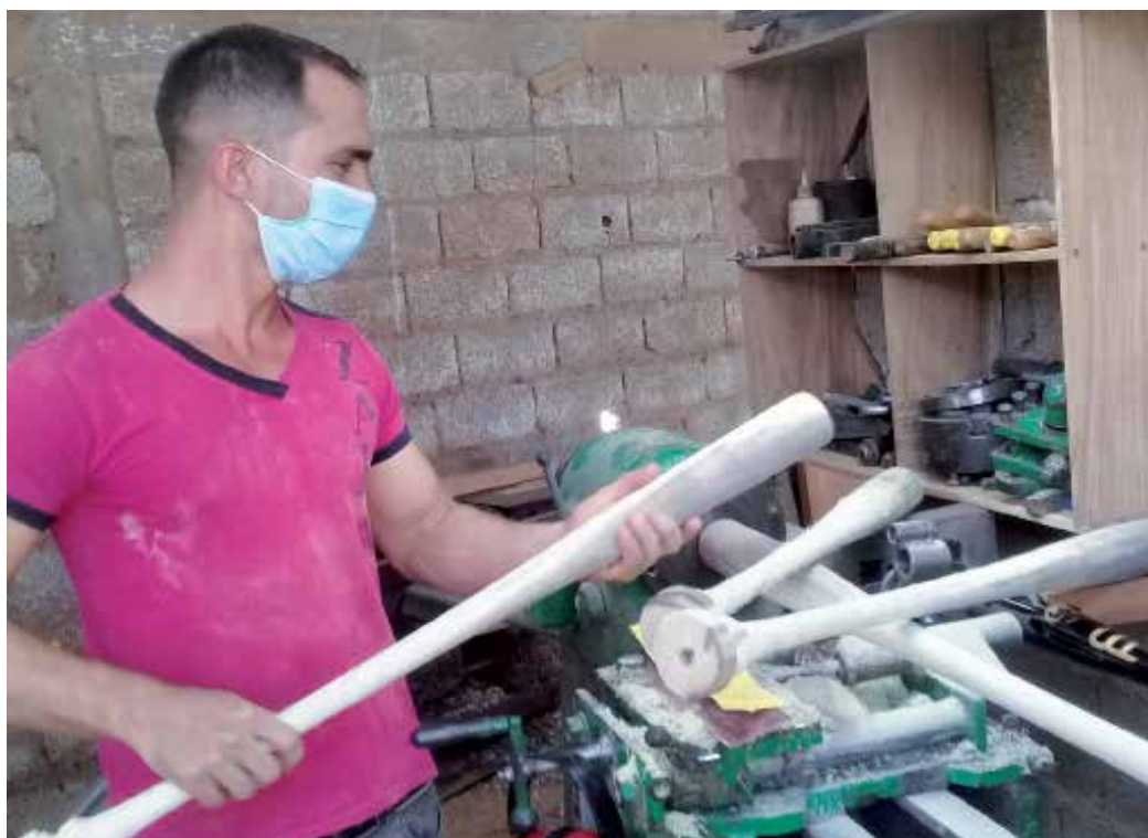
En el torno copiator Iván Carballo elabora el bate y lo lija.
