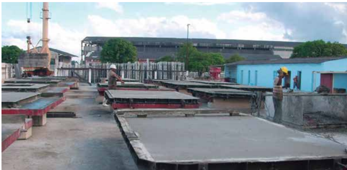
En la planta Gran Panel se confeccionan piezas de prefabricado para los edificios que se levantan en la provincia.
