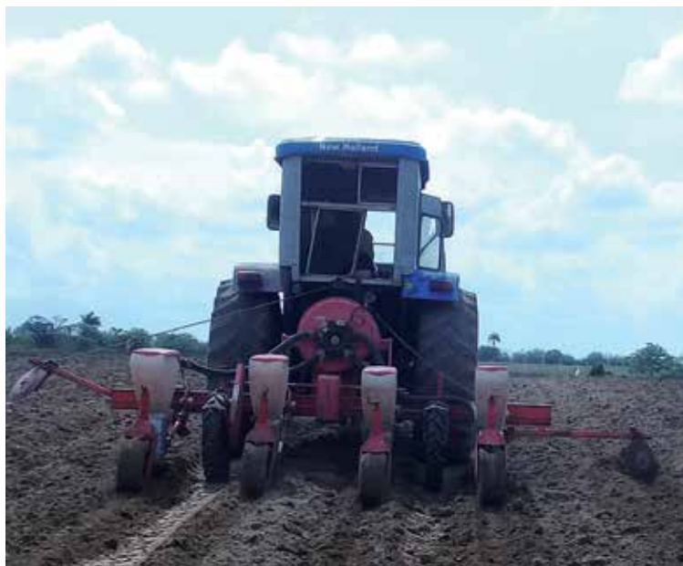
La siembra mecanizada de los granos favorece la germinación y optimiza el uso de la semilla.
