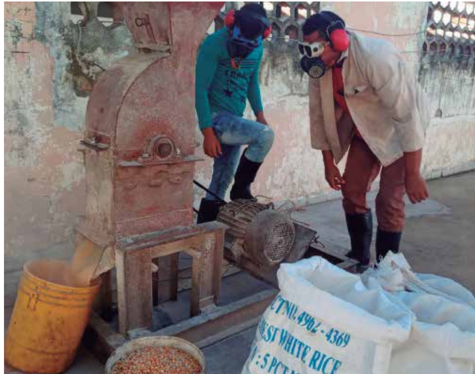
La falta de corriente trifásica constituye uno de los mayores problemas para aprovechar toda la capacidad instalada de la minindustria.
